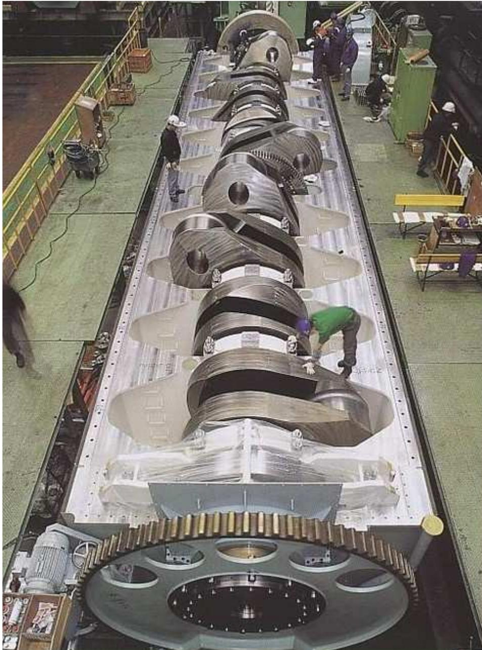
Longueur bloc moteur : 26.60m – 16 cylindres – 2300 tonnes – vitesse rotation : 102 trs/mn
